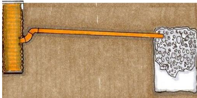
Figur 6 Billedet viser en type faskine, som er opbygget af en hul fyldt med sten
